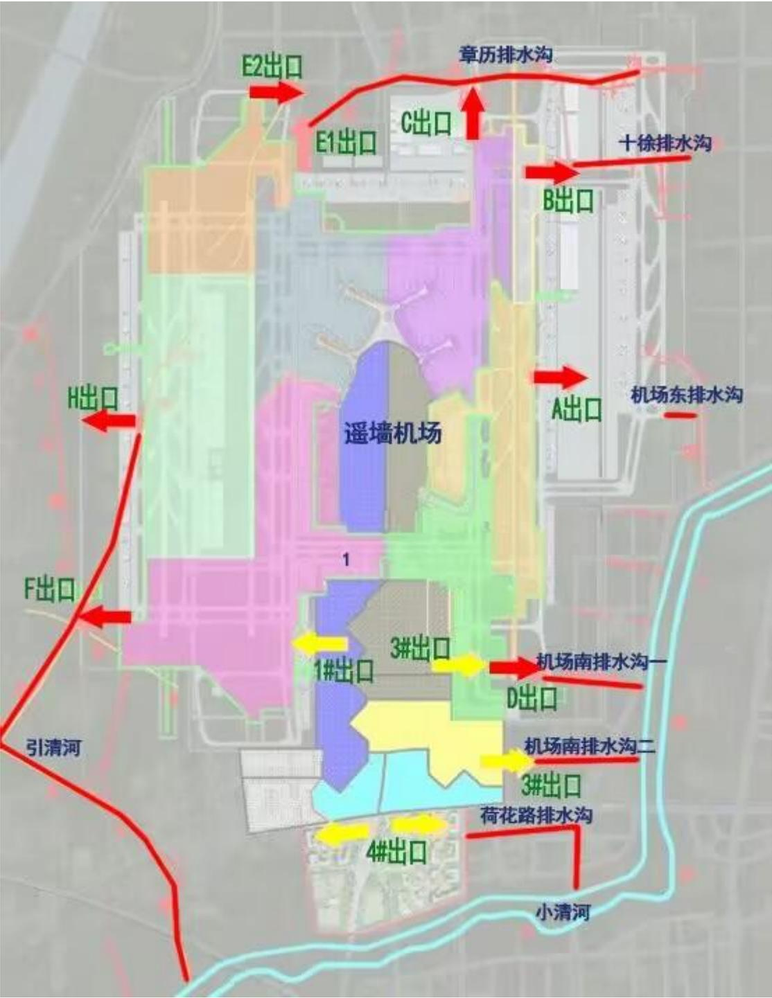
图 4.1-11 遥墙机场雨水分区及排水口分布图
